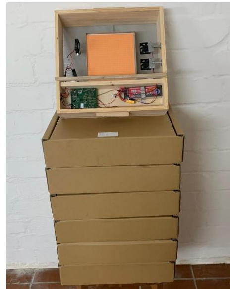
Bilder 4: Vorbereitung für die MAJA-Anwendungstests; MAJA-Verdunstungseinheit vorbereitet als passfähiger (temporärer) Einsatz für die Segeberger Beute sowie Vervielfältigung des Prototyps in 7-facher Ausfertigung für die weiteren MAJA-Prototypentests beim OG-Partner Imkerei Tietjen
