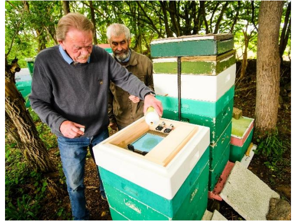
Bilder 3: Vorbereitung für die Anwendungstests; Prototypentest einer MAJA-Verdunstungseinheit an einem Bienenstock im Feld
